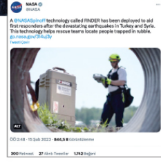
NASA'nın geliştirdiği FINDER teknoloji, mikrodalga radar kullanarak kalp atışı ya da nefes alıp verme sonucu oluşan çok küçük vücut hareketlerini belirler. Cihaz, ilk olarak 2015 yılındaki Nepal
